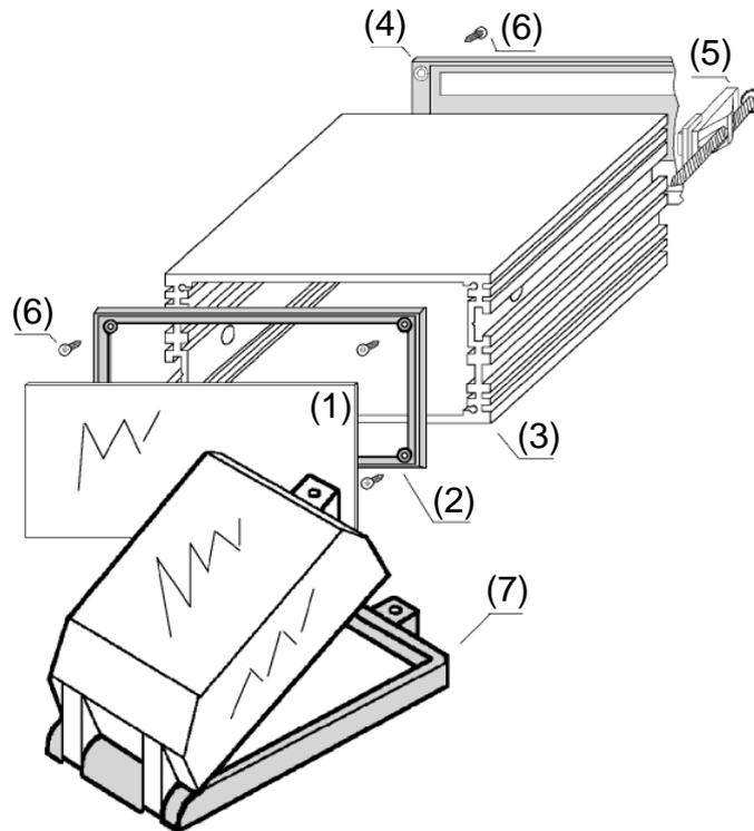
(1) VORDERSEITE AUS GANZ GESCHLOSSENEM ALUMINIUM, DICKE 15/10 OXIDIERT SILBER MIT „PEELING“. BEREIT FÜR JEDE ANPASSUNG „BENUTZERDEFINIERT“ PERFORATIONEN UND MÖGLICHER SIEBDRUCK
