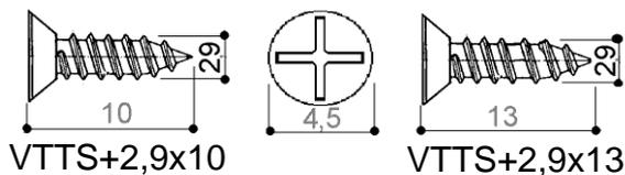
Spezielle selbstschneidende Schrauben mit Durchmesserkopf reduziert und quer geschnitten.
